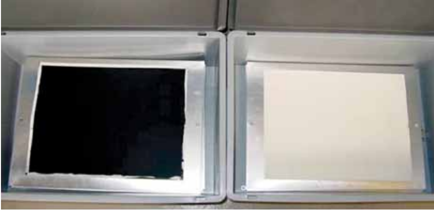
Figura 14: prove su filtro di un motore diesel (a sinistra) e su una stufa a caricamento automatico (a destra).
