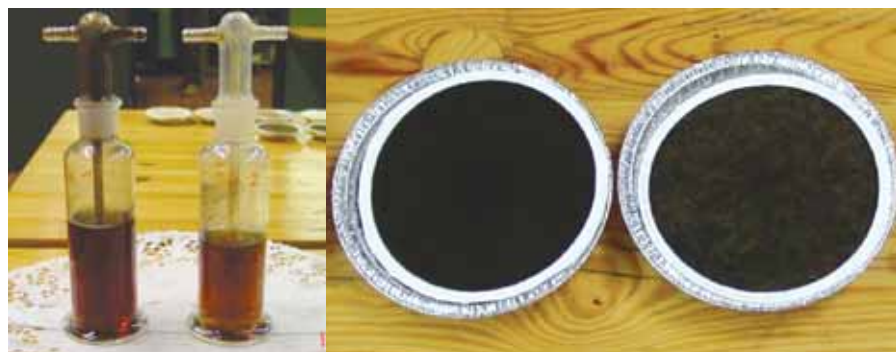
Figura 13: ripartizione granulare delle particelle nei fumi della stufa a pellet con funzionamento a pellet di legno e di cereali.
